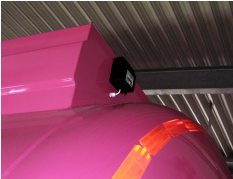
Praxisbeispiel Einbau eines SECU MultiGPS auf einem Tankwagen
